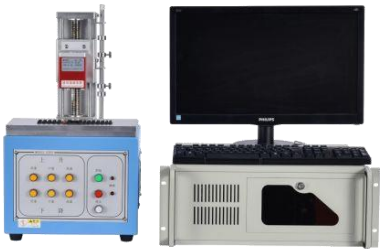
Automatic load shift curve meter
